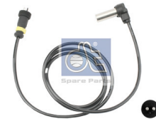
Toerentalsensor repl. VDO: 340 804 077 011 / L=1600 mm DT 4.62918 · repl. Mercedes 001 153 0420
